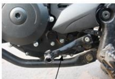
پیچ تخلیه روغن موتور درون کارتر
