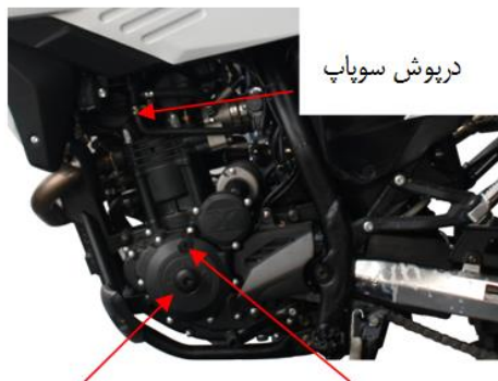
درپوش سوپاپ درپوش سوراخ تایمینگ جرعه
