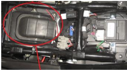
مجموعه هواکش و محل بازکردن فیلتر
