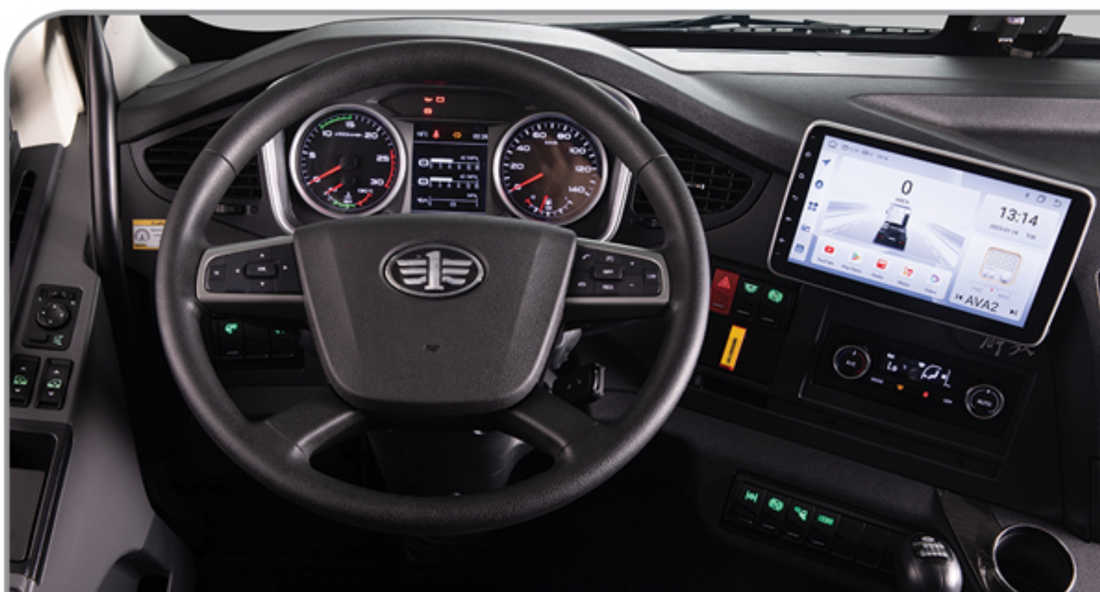
غریبک فرمان مجهز به کلیدهای دسترسی به مولتی مدیا و کروز کنترل
