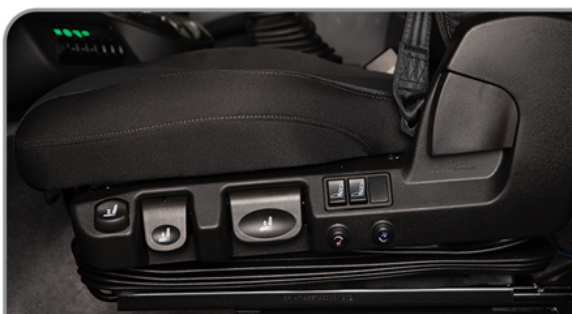
صندلی راننده با تعلیق پنوماتیک، دارای گرم کن و سردکن و قابلیت تنظیم در ۶ جهت
