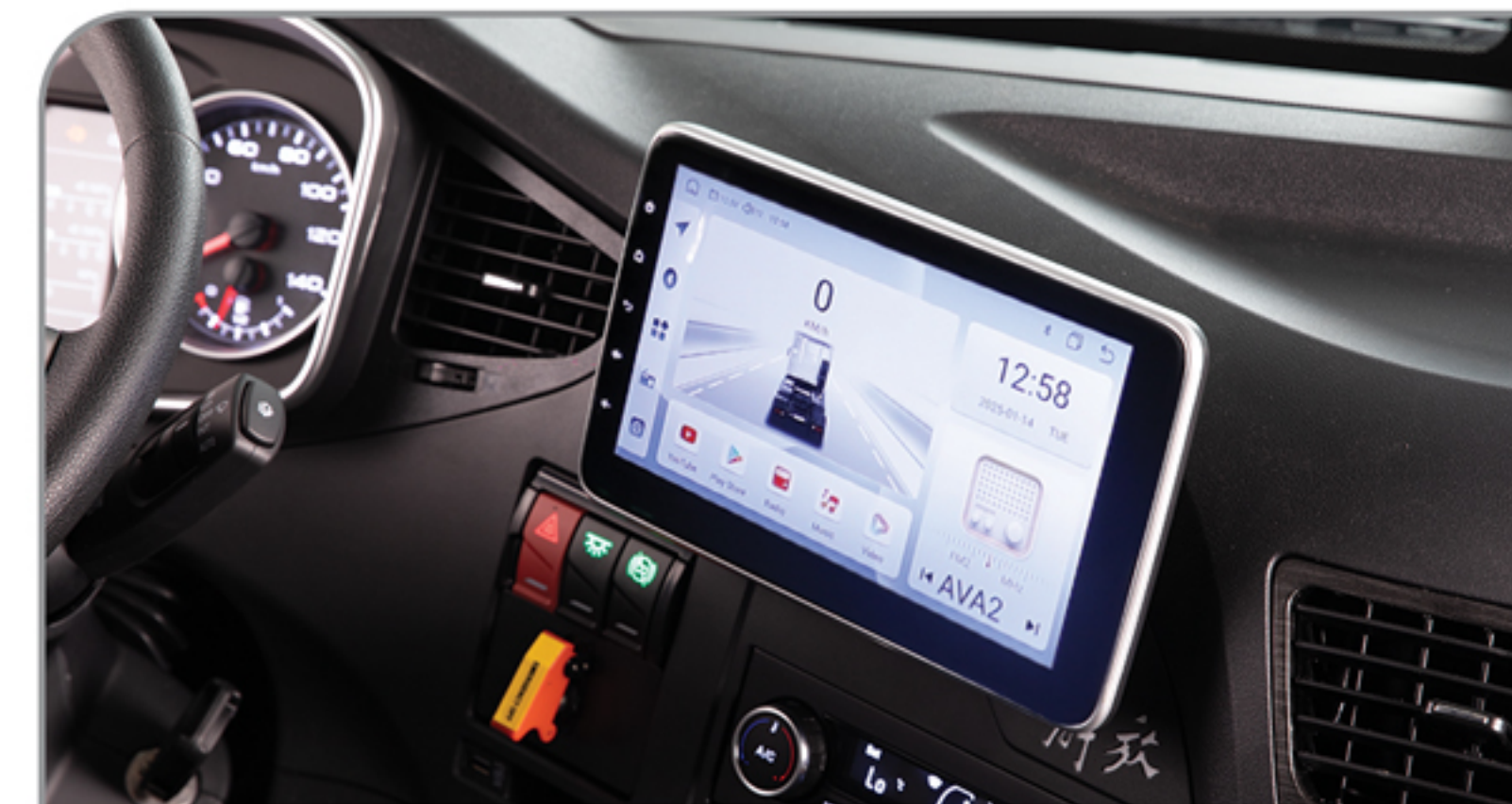
مولتی مدیا TFT لمسی (رادیو، رهیاب، بلوتوث، دوربین ۴ جهته، USB)
