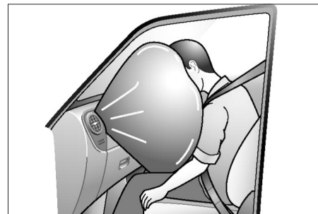
ایربگ سرنشین جلو در جلو داشبورد روبروی سرنشین جلو تعبیه شده است. V
