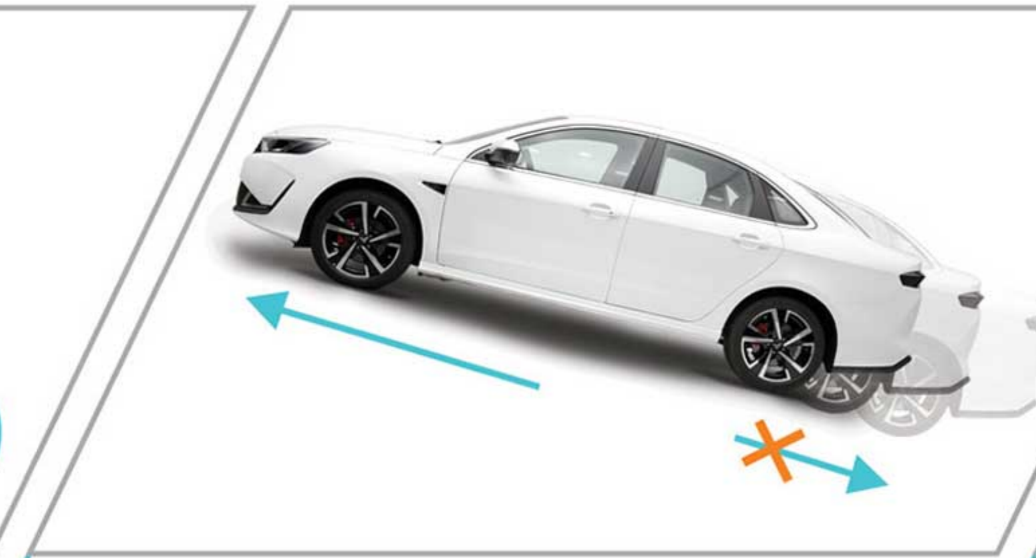
سیستم کنترل حرکت خودرو در سر بالایی HAC
