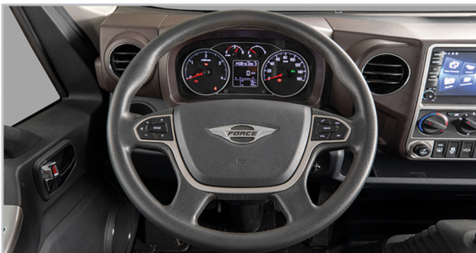
غریبک فرمان مجهز به کلیدهای دسترسی به مولتی مدیا و کروزر کنترل
