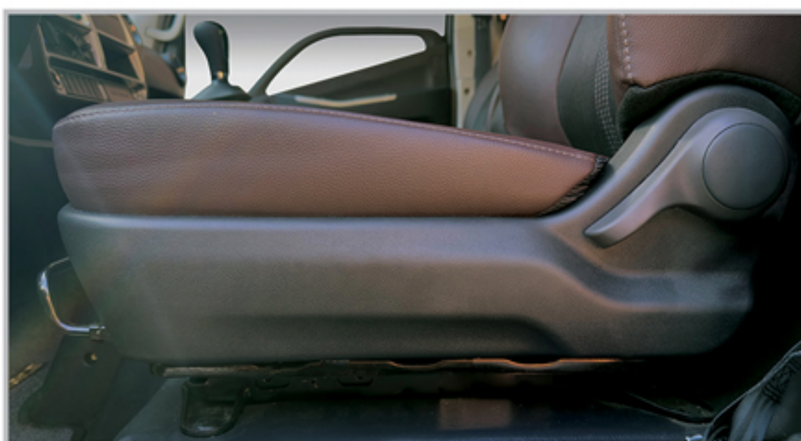
صندلی راننده با تعلیق مکانیکی و قابلیت تنظیم در ۶ جهت
